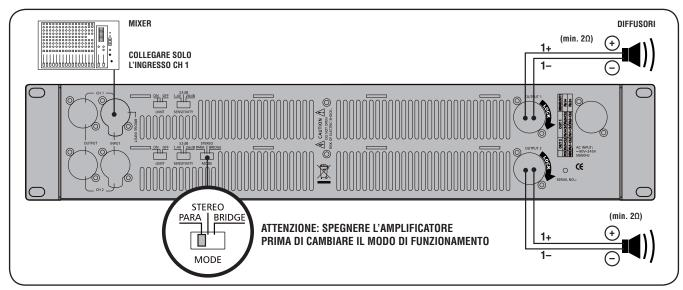
Come cablaggio alternativo, l'uscita 2 dell'amplificatore è anche disponibile sul connettore SPEAKON dell'uscita 1(poli: 2+ positivo, 2– negativo).
