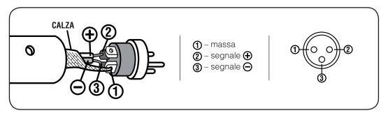
8 Uscita audio parallela (una per canale, connettore XLR maschio)
