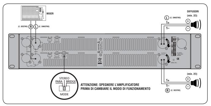
Come cablaggio alternativo, l'uscita 2 dell'amplificatore è anche disponibile sul connettore SPEAKON dell'uscita 1(poli: 2+ positivo, 2- negativo).
