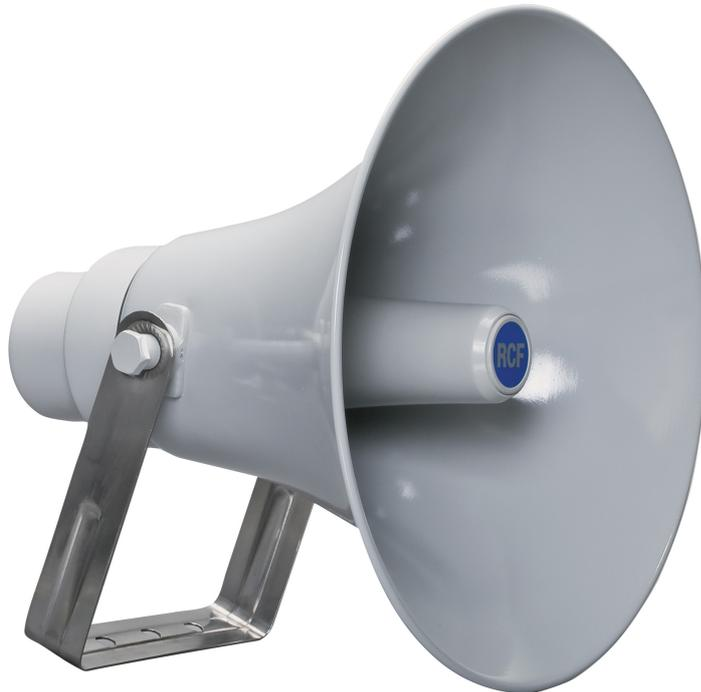
**Descrizione** HD 410/T è un diffusore a tromba compatto a tenuta stagna progettato per fornire un'elevata efficienza. Si caratterizza per una riproduzione del suono ad elevata intelligibilità, unita ad una bassa distorsione. Il trasformatore di linea che li equipaggia permette il collegamento a linee a tensione costante di 70 e 100V, con possibilità di selezionare la potenza diffusa tramite un commutatore rotativo accessibile dall'esterno.
