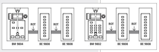
Befestigen Sie das erste BE 9808 an das BM 9802 / BM 9804 (und alle BE 9808 miteinander), indem Sie die spezielle Platte (im BE 9808 Paket) und vier Schrauben verwenden.
