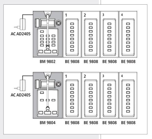
Jede BE 9808 wird direkt über das verbundene BM 9802 / BM 9804-Mikrofon (24 V dc, entweder über Bus oder durch externen Adapter, d.h. WS AD2405 optional) mit dem Paging-Mikrofon verbunden.
