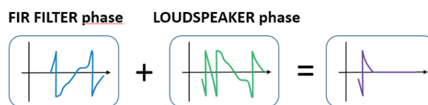
Fig.3 - suma de la fase del filtro FIR con la fase del altavoz
