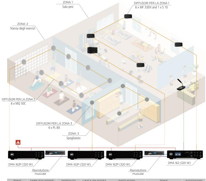
Uscita amplificatore — Ingresso audio — Accessori — Bus audio a 4 canali — Comando "Mute" da sistema antincendio
