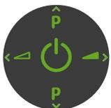
Il colore della retro-illuminazione del joystick indica l'attuale stato del sistema e della zona controllata.
